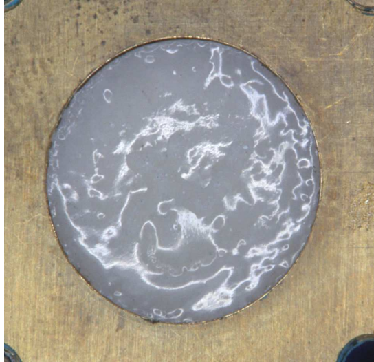
Abb.5: Die Keramikinlays (einflächig) wurden in die Kavität zurückgesetzt und die Randspalten vermessen.
