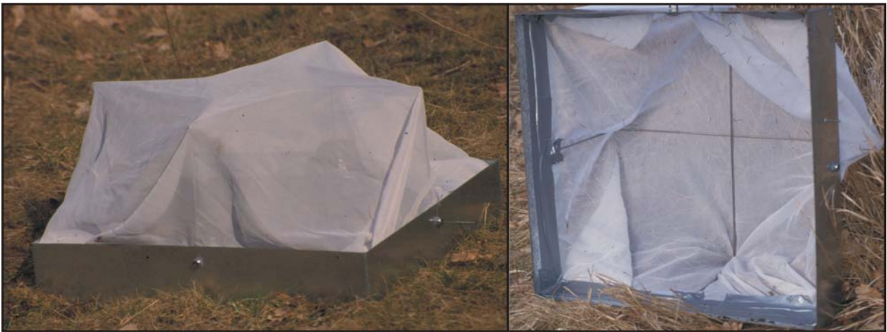
Abb. 6: Schlupffallen zur Ermittlung der Qualität einzelner Weideelemente als Eiablagehabitat im Geländeeinsatz (links). Das Metallkreuz, auf dem die Gaze aufgespannt wird, ist mit 4 Muttern am Stahlrahmen befestigt (rechts). Fotos nachgestellt.
