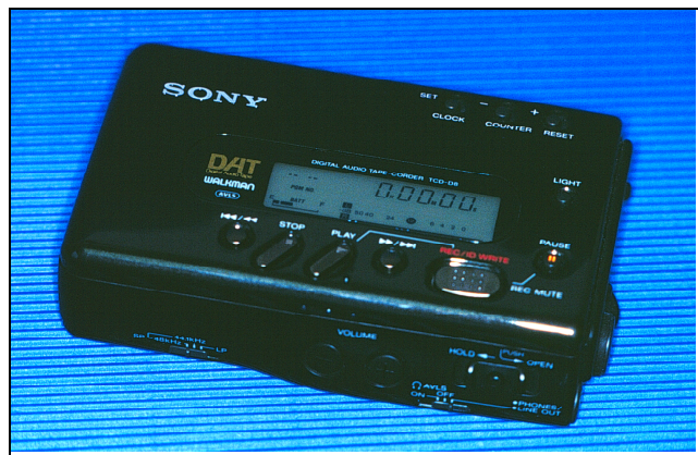
Abb. 3.5.1: Die Tonaufnahme Oben: Positionierung des Richtmikrophons und Lesehaltung während der Tonaufnahme Mitte: Richtmikrofon (Fa. Phonax) in gummierter Halterung Unten: DAT-Recorder (Fa. Sony) zur digitalen Tonaufzeichnung
