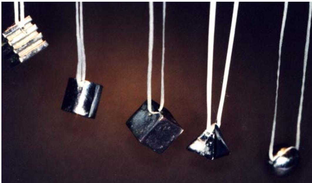
Abb. 4: Auswahl von 5 durch Zahnseide gesicherte Testkörper für den R.F.-Test
