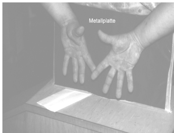
Abbildung 2-13: Versuchsaufbau der telethermographischen Messung
