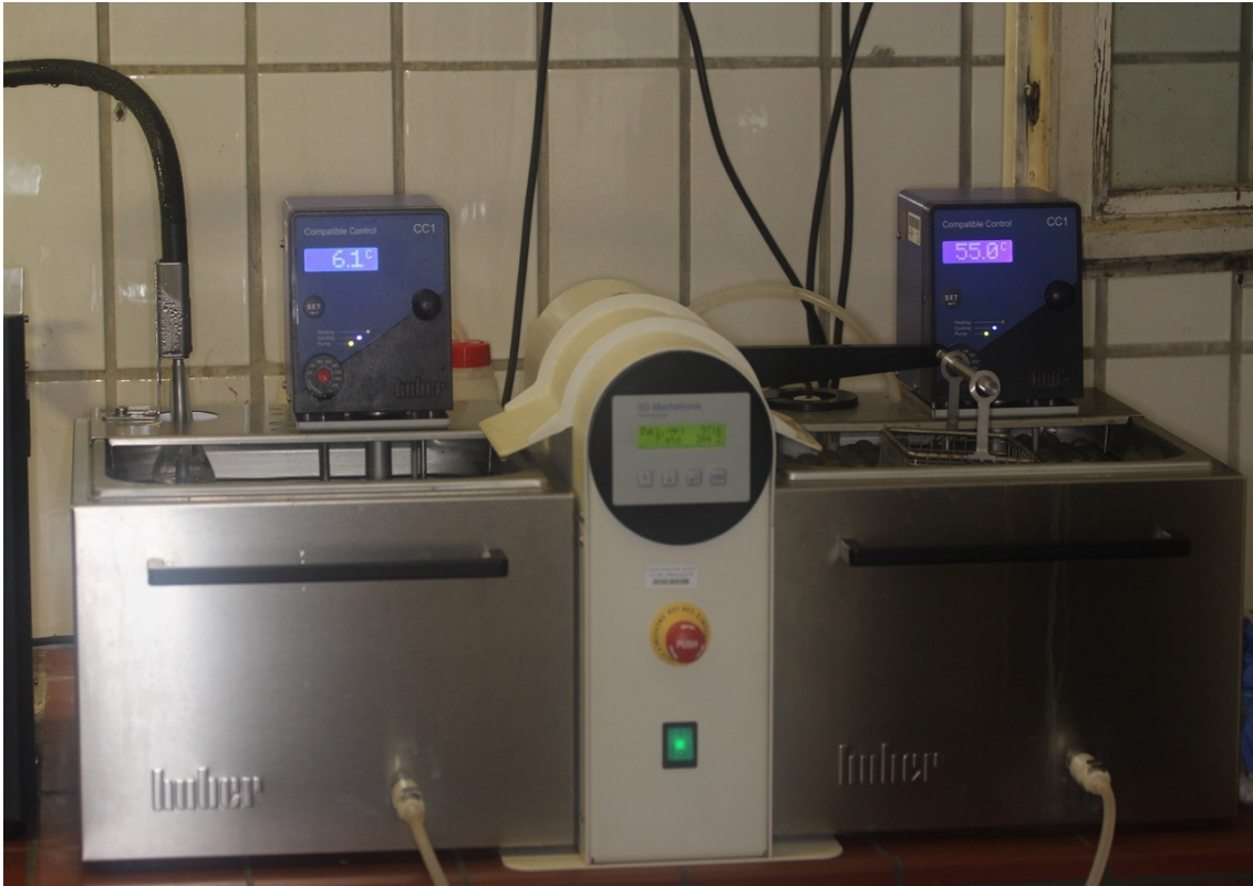
Abbildung 13: Der verwendete Thermocycler für die vorliegende Studie (THE 1100/1200, SD Mechatronik GmbH, Feldkirchen-Westerham, Deutschland)
