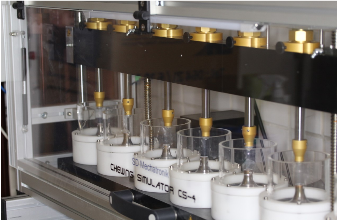
Abbildung 14: Der verwendete Kausimulator für die vorliegende Studie (CS-4, Fa. 3D Mechatronik, Feldkirchen-Westerham, Deutschland)
