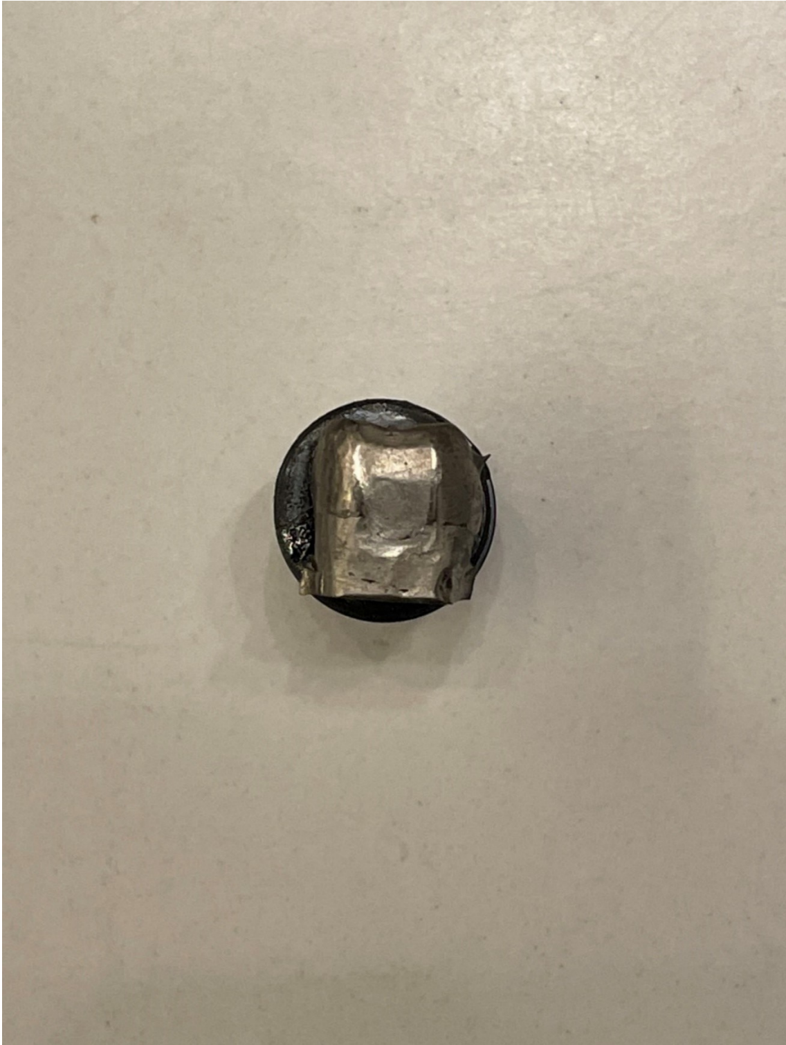
Abbildung 15: Beispiel für ein befestigtes Epoxidharz-Replika auf einem Metallträger für die REM-Analyse
