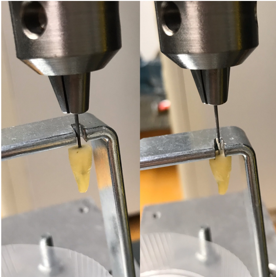
Abbildung 9-5: Beispielzahn v. l. n. r.: kurz vor und während des Pull-Out-Verfahrens
