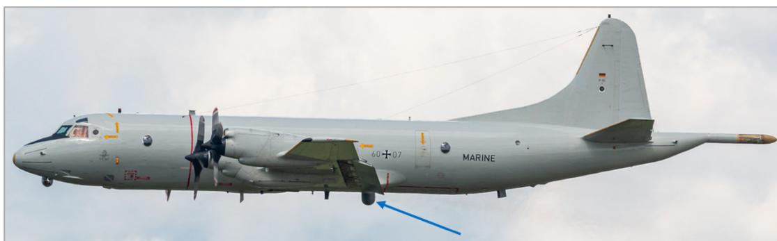
Abbildung 25: Propellerflugzeug „P-3C Orion“; der Pfeil verweist auf das Infrarotsensorsystem MX-20D
