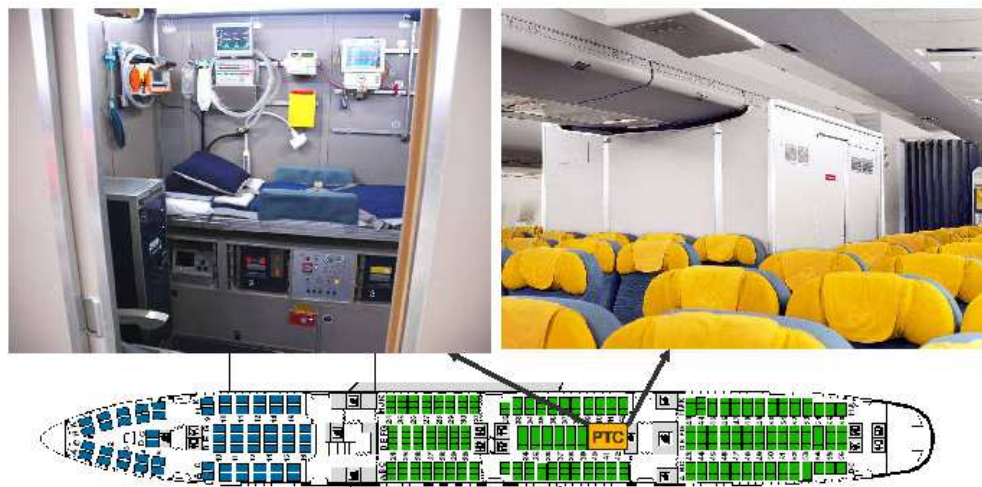
Abbildung 9: Eingebautes PTC Modul am Beispiel einer B 747 (Quelle: Deutsche Lufthansa, Frankfurt/Main)
