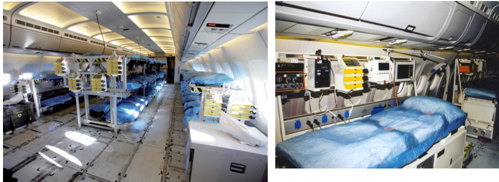
Abbildung 4: Der Airbus A310 der Bundeswehr mit eingebauten Intensivbehandlungseinheiten (links); Eine Behandlungseinheit der Bundeswehr (rechts); (Quelle: Bundeswehr)
