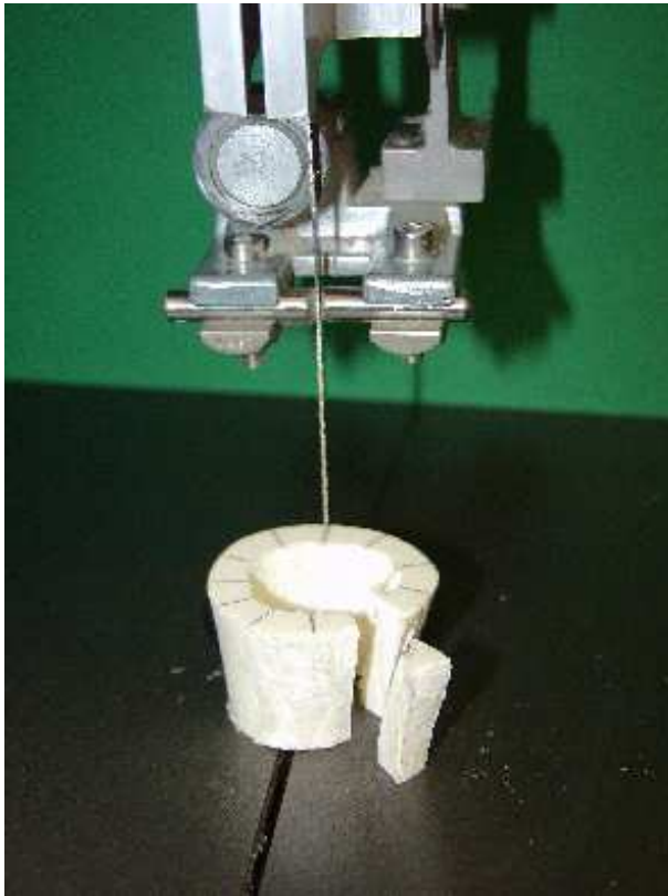
Abb. 3-1c Zerteilung eines Diaphysensegmentes in trapezförmige Längssegmente mit der Bandsäge
