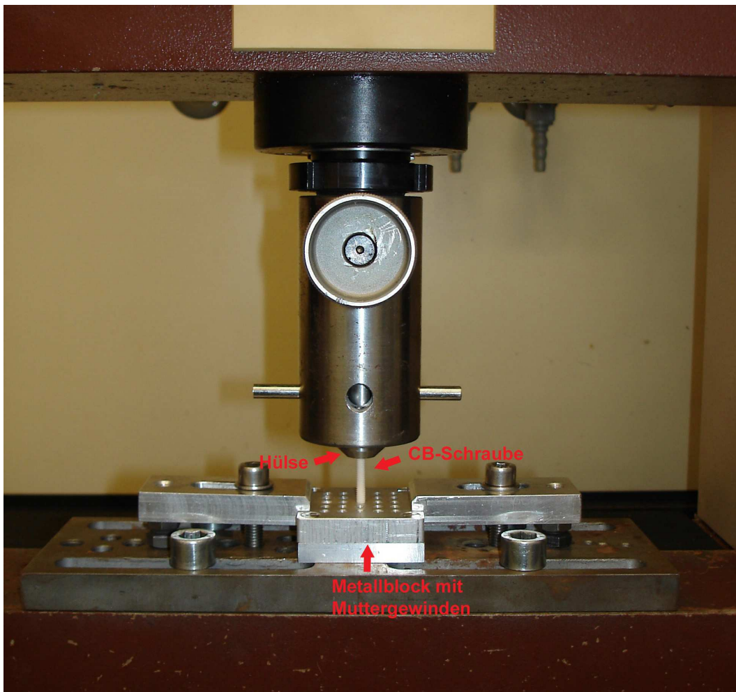
Abb. 3.3.3b Versuchsaufbau für die Zugbelastung der CB-Schrauben im Foto
