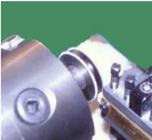
Abb. 3-1e Einschneiden der Flanken am Schraubenkopf
