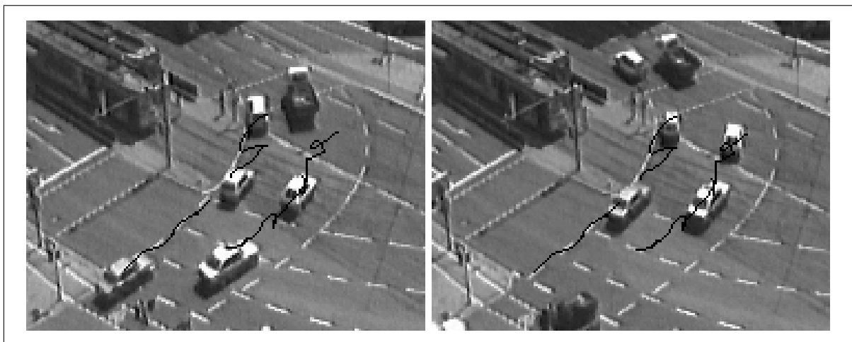
Abbildung 5.3: Übersicht über die Verfolgung vier verschiedener Autos im Beispiel Durlacher Tor. Die gleichen Trajektorien aus vier verschiedenen Simulationen sind in das Anfangsbild (links) und das Endbild (rechts) der Sequenz nach 1000 Bin eingezeichnet. Das kurzzeitige 'Zurücklaufen' in der Mitte der linken oberen Trajektorie entstand beim Wechsel des Aufmerksamkeitsfokus von der rechten auf die linke Kante des verfolgten Autos.
